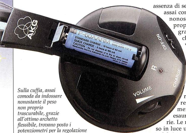
*Sulla cuffia, assai comoda da indossare nonostante il peso non proprio trascurabile, grazie all'ottimo archetto flessibile, trovano posto i potenziometri per la regolazione della frequenza di ricezione e del volume di ascolto.*
